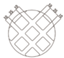
ネット部拡大図 仕様：銅板・ステンレス t=1.6
