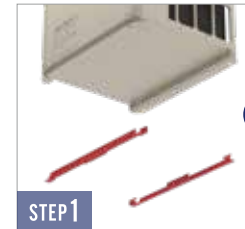
▼ 金具を室外機の内側に取付ける
