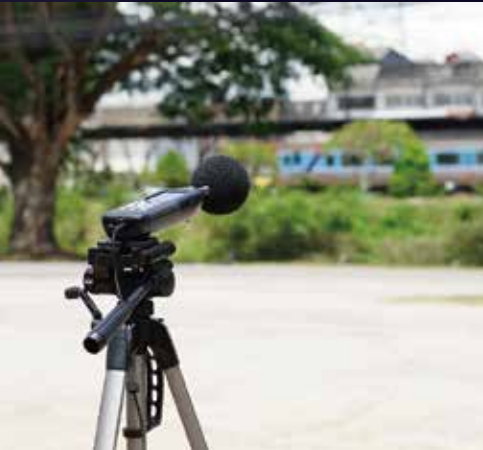
騒音計を用いた騒音測定
