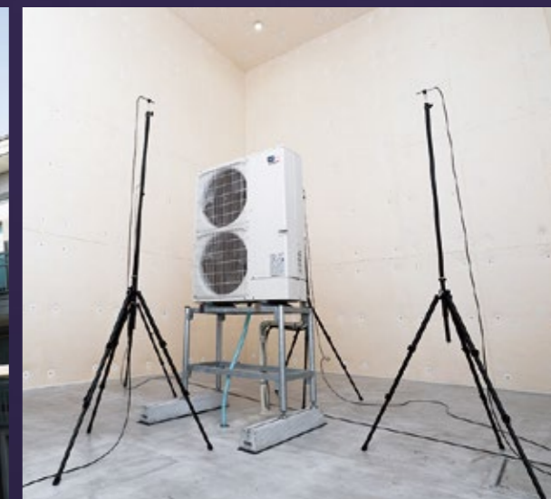
ヤブシタ研究所の半無響音室実験棟。半自由音場である半無響音室で空調室外機の騒音値や防音製品の効果を測定しています。
