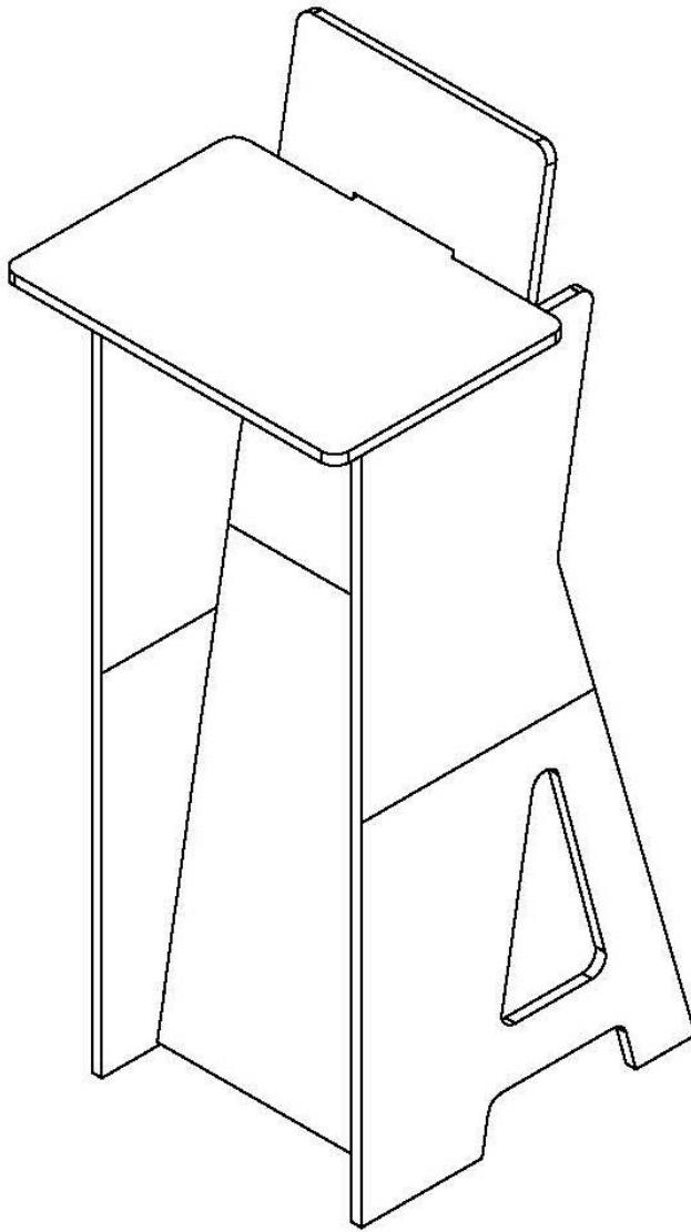
本製品は、紙製ハニカム構造板「リボード（Re-board）」を使用した、組み立てや持ち運び、収納が簡単に行える組立式のプレゼン台です。パーツ同士を差し込むだけでどなたでも短時間で設置でき、専用工具も不要です。軽量設計のため持ち運びやレイアウト変更もスムーズで、使い終わった後もコンパクトに分解・保管できます。勉強会や展示会、各種イベントなど、多様な場面でご利用いただけます。簡便性と実用性を兼ね備えた、現場で“ちょうどいい”プレゼン台です。
