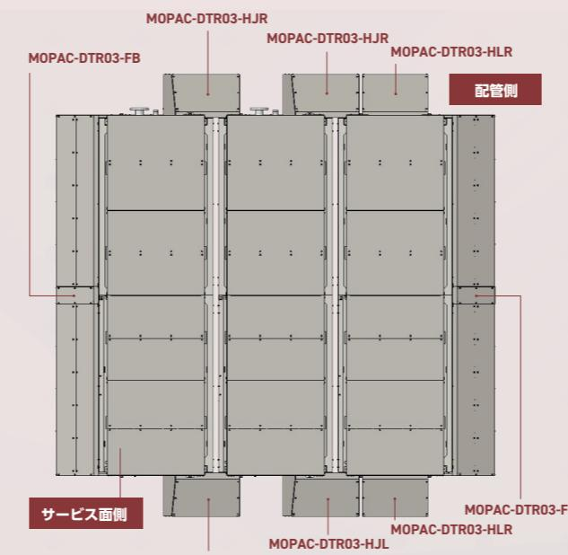
連接設置時（室外機3台）吸込側構成図
