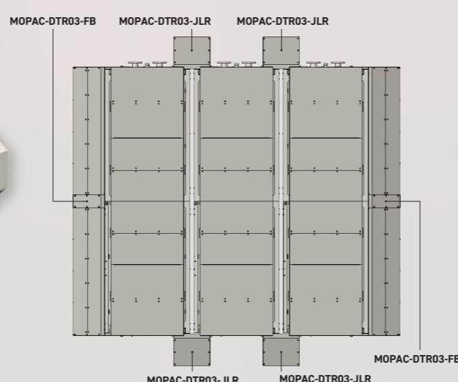
連接設置時（室外機3台）吸込側構成図
